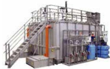
采用BC工艺对低C/N比污水进行脱氮中试实验研究,在BioDopp生化反应器内投加芽孢杆菌,同步投加促进剂,保证芽孢杆菌在反应器内优势地位和活性,利用芽孢杆菌特殊的脱氮能力,在C/N=2~3时,实现了出水总氮的达标排放,在较低的水温条件下,也能得到较好的处理效果。
